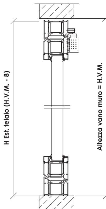
Chiusura tagliafuoco con struttura d'acciaio coibentata, ed omologata conforme alla UNI EN 1634-1 denominata "VITREX F4" costituita da:
