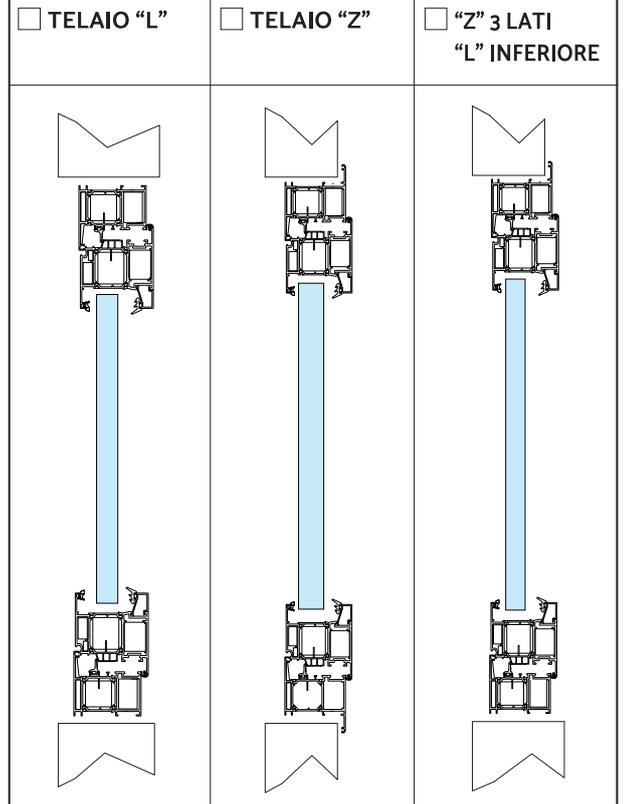
**TIPOLOGIE DI FISSAGGIO**
